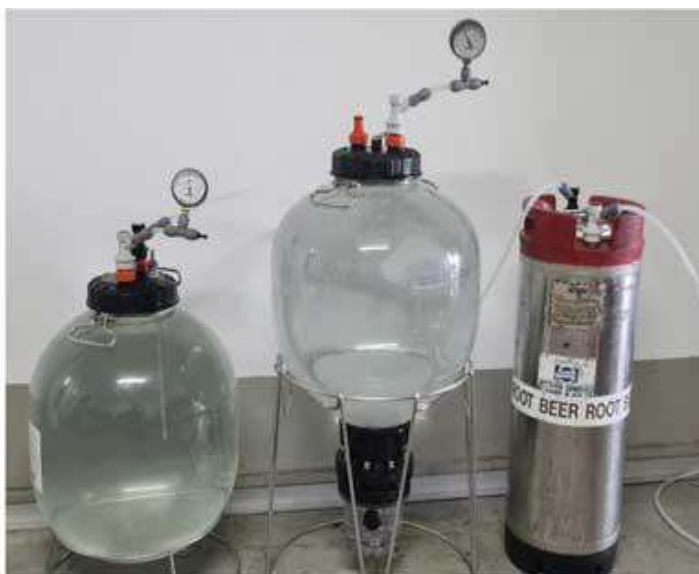
В ферментерах All Rounder 30 л и ЦКТ/Unitank 27 л повышенное давление – 4,5 атм. Во время гидротестирования
