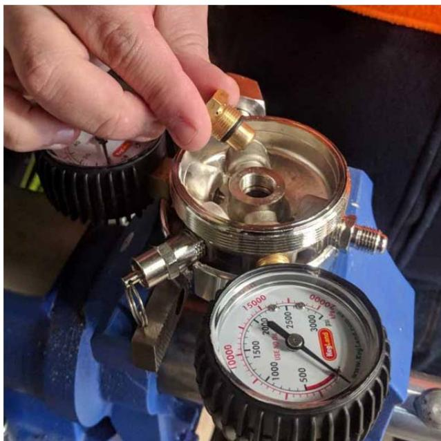
После установки нового узла седла и колпачка седла вставьте его обратно в корпус регулятора и затяните торцевым ключом на 16 мм.
