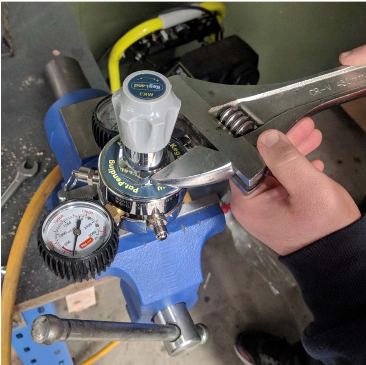
Снимите крышку (bonnet) с регулятора с помощью большого разводного ключа.
