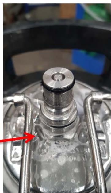
**Шаг 5.** Если пузырьки не образовались, сбросьте давление в кеге и оставьте его подключенным к водопроводу на несколько часов. По истечении этого времени отключите подачу воды от крышки карбонизатора и снимите её с кега. Если кег полон до краев, это указывает на наличие утечки.
