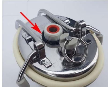
**Шаг 6.** Вставьте шайбу 5/8" в фитинг ball lock, затем от руки накрутите фитинг на резьбу, после чего поверните его еще на  $\frac{1}{4}$  оборота с помощью гаечного ключа подходящего размера. Убедитесь, что сопло распылителя расположено правильно, как показано на схеме ниже. Сопло должно находиться прямо напротив предохранительного клапана.
