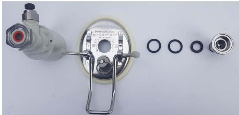
**Шаг 3.** Затяните от руки по часовой стрелке шестигранную гайку, расположенную над поплавковым механизмом. Если не затянуть ее перед сборкой крышки карбонизатора, это приведет к её утечке из-за недостаточного сжатия верхнего уплотнительного кольца.
