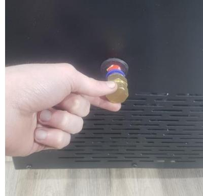
Чтобы снять латунный фитинг  $\frac{1}{2}$  дюйма со сливного патрубка, потяните синее кольцо (цангу) на себя, одновременно стягивая латунный фитинг. Не вращайте фитинг при снятии, так как это может повредить (порезать) сливной патрубок, что приведет к потере герметичности при повторной сборке.
