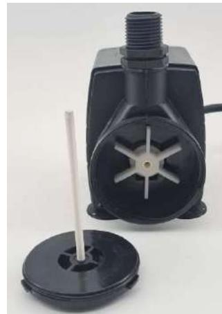
**Шаг 4.** Вытащите крыльчатку из гнезда. Будьте аккуратны, вытаскивая крыльчатку — в насос установлен довольно сильный магнит, он может довольно сильно и резко потянуть крыльчатку обратно.
