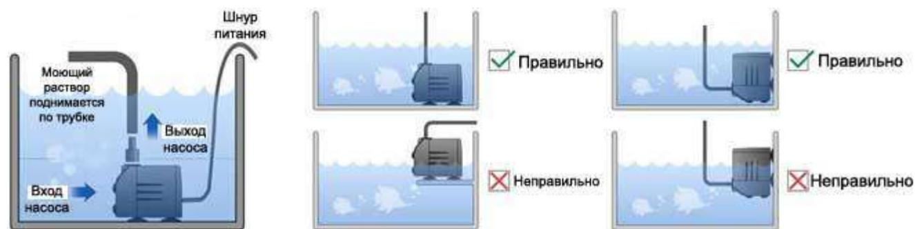
Скорость потока насос просто регулировать, меняя размер входного отверстия насоса (см. картинку ниже).
